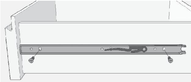
Fixe o trilho retirado na lateral de gaveta, usando o furo de regulação.
