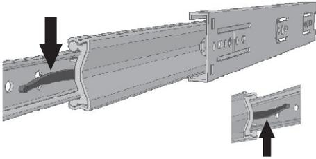
Abra a corredeira até o limite máximo e desconecte o trilho menor, pressionando a parte central da alavanca.
