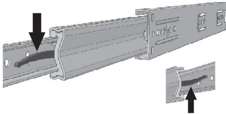
Abra a corrediça até o limite máximo e desconecte o trilho menor, pressionando a parte central da alavanca.
